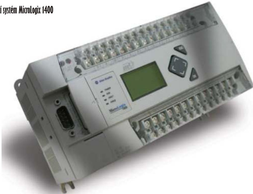
V průběhu tohoto roku bude uveden na trh nový řídicí systém s označením MicroLogix1400. Tento nový řídí systém vychází z velmi úspěšného a rozšířeného řídicího systému MicroLogix1100. V praxi to znamená, že vše co bylo možné s MicroLogix 1100 bude možné i s MicroLogix 1400 a navíc přidává několik vylepšení.
